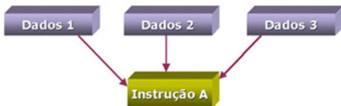
O processador executa as mesmas instruções sobre dados diferentes. É aplicado, por exemplo, em programas que utilizam matrizes imensas e para cálculos de elementos finitos.
