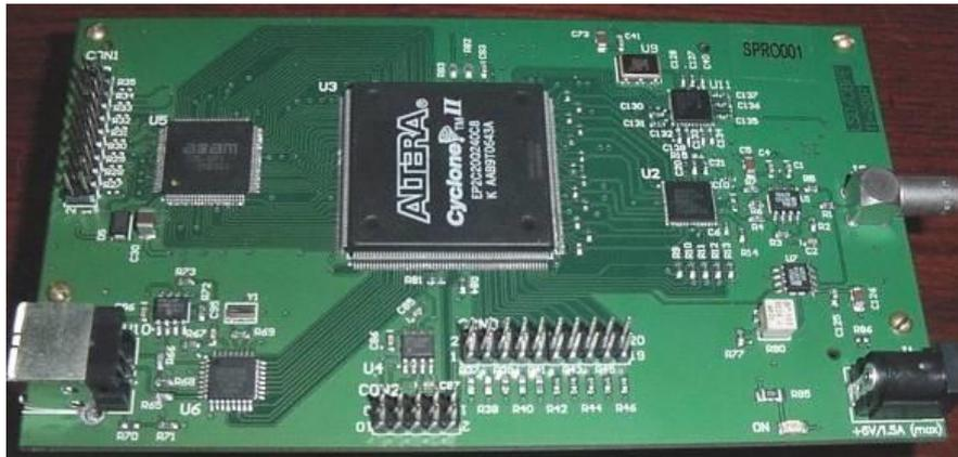
Figura 10: módulo protótipo da eletrônica de *aquisição de dados*, que fornece carga e tempo da chegada do sinal em cada fotomultiplicadora.
