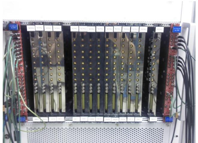
Figura 11: módulo final NDAQ, com 8 canais (ADC e TDC), e crate VME com 14 módulos finais NDAQ
