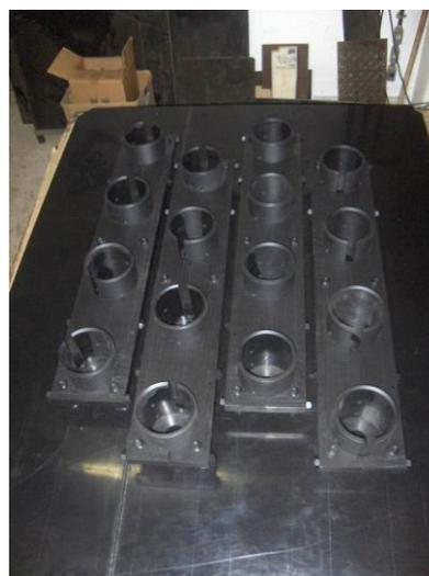
Figura 4: Fotomultiplicadoras e base de polietileno para fixação das 16 PMT da base do detector.
