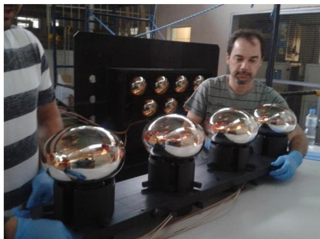
Figura 12: início da montagem e dos testes no CBPF com o tanque de blindagem superior (veto ativo) e das fotomultiplicadoras da base do detector que servirá como alvo para as interações de neutrinos.
