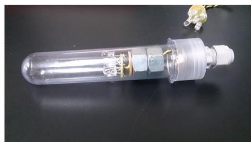
Figura 1: montagem de sistema de calibração usando três LEDs de diferentes comprimentos de onda.
