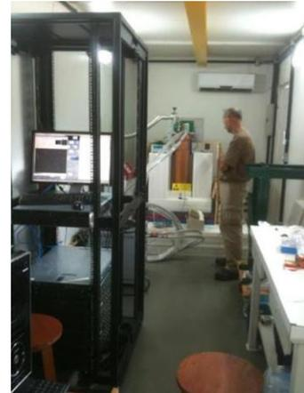
Figura 3: CCD do experimento CONNIE e o início de sua montagem no laboratório de neutrinos em Angra
