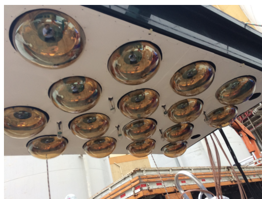
(b) Tampa superior com as fotomultiplicadoras do topo do Alvo.
