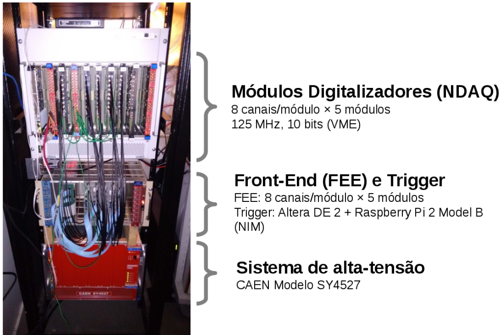
Figura 92 – Fotografia do rack contendo a eletrônica de aquisição do experimento Neutrinos Angra.
