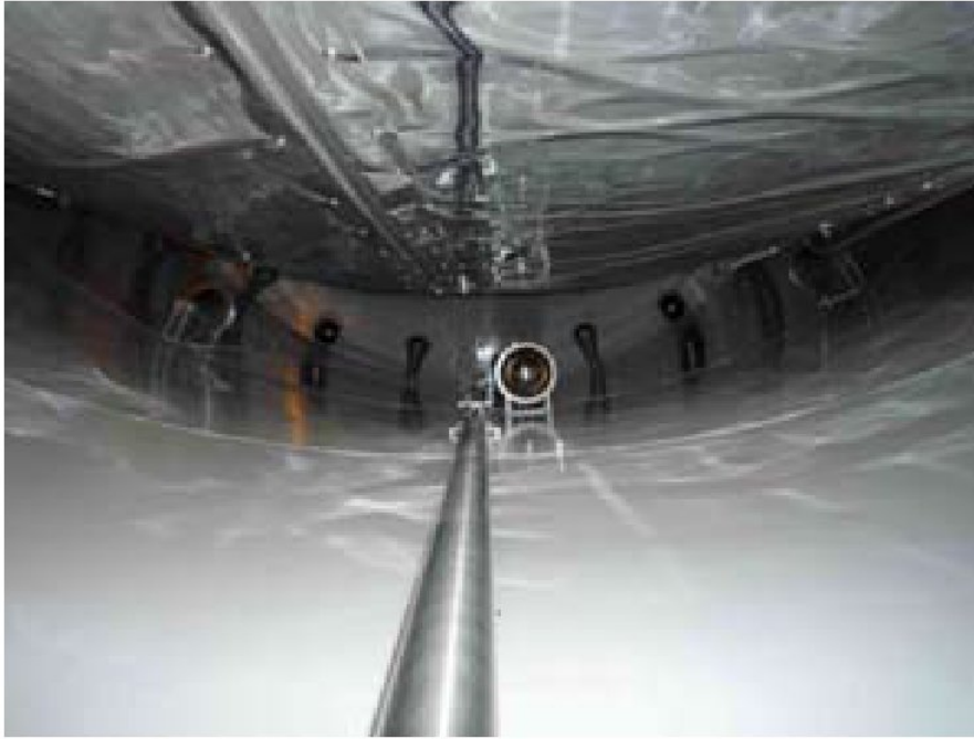
Figura 16 – Fotografia da parede lateral do Inner Veto no laboratório do Far Detector antes do preenchimento com cintilador líquido (20).
