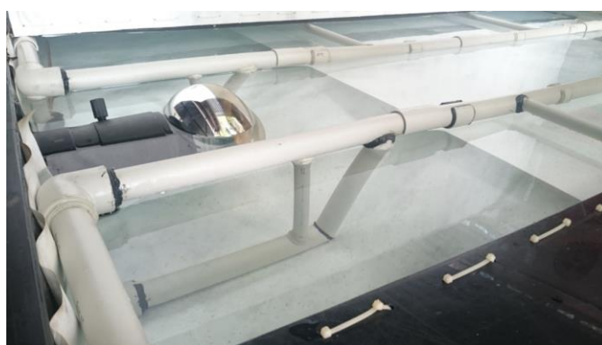
Figura 63. Veto superior com Tyvek suspenso e nível de água baixo.
