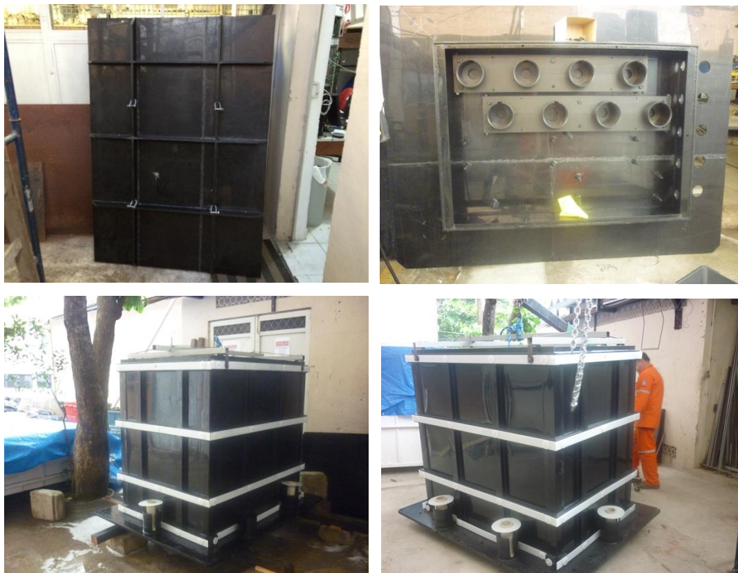
Figura 40. Target e tampa do detector novos. No verso da tampa estão duas réguas com copos de polipropileno que acomodam PMTs. Acima: Tampa do detector. Abaixo: Target .
