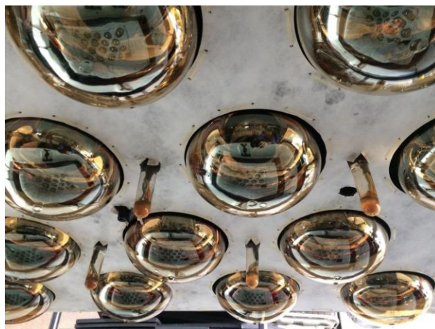
Figura 64. Iluminadores a LED da tampa do Target com particulado ferruginoso precipitado.
