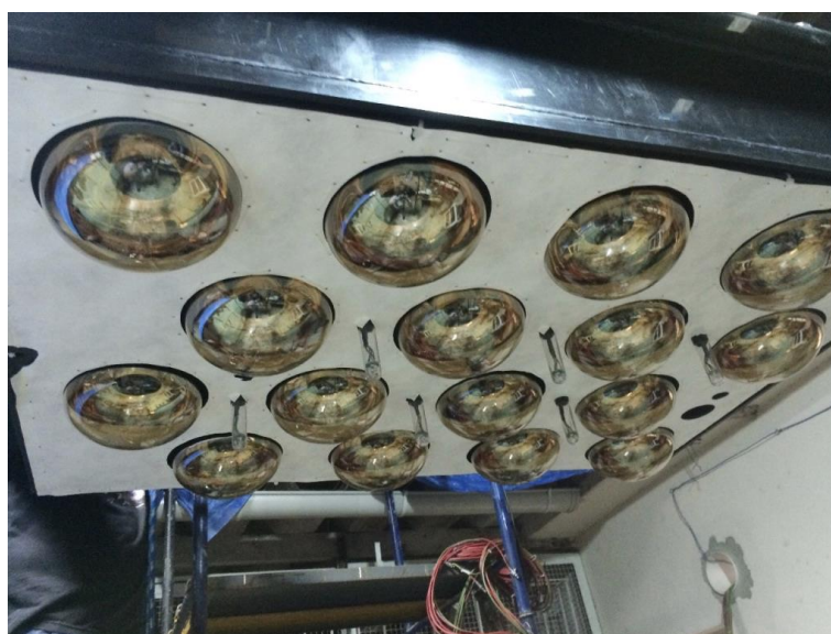
Figura 59. Vista inferior da tampa do Target instrumentada com PMTs e iluminadores a LED.
