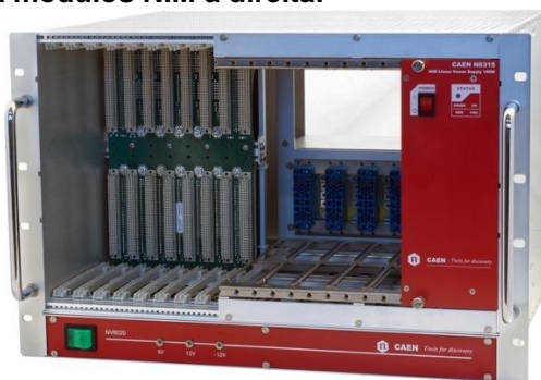
Figura 9. Crate de instrumentação CAEN misto, com conectores para módulos padrão VME à esquerda e conectores para módulos NIM à direita.
