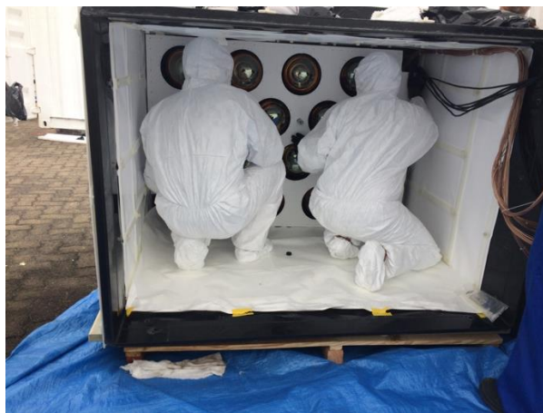
Figura 68. Montagem das PMTs no fundo do Target .
