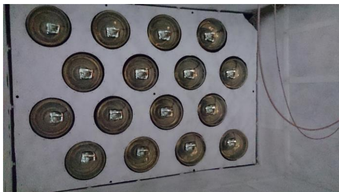
Figura 53. 16 PMTs no fundo do Target .
