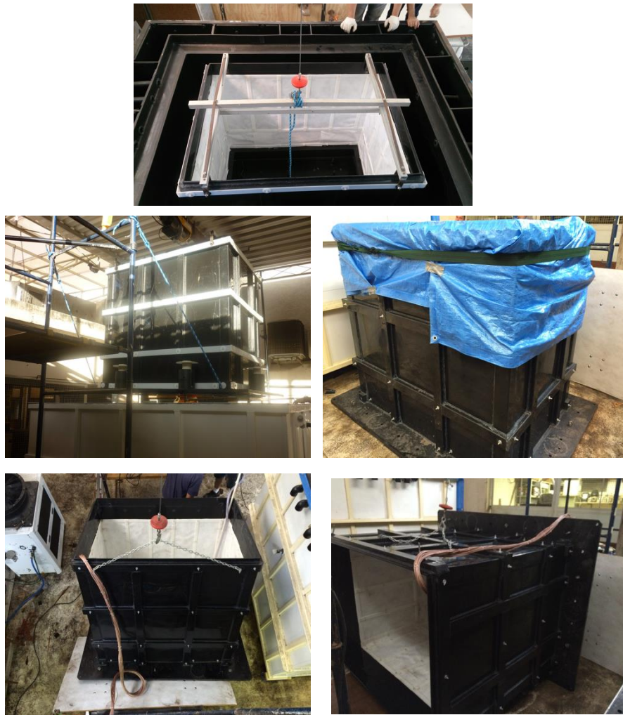
Figura 44. Sequência de retirada do Target do detector e disposição para trabalho interno.
