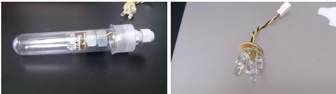
Figura 43. Esquerda: pulsador de LED de alto brilho. Direita: detalhe dos LEDs do pulsador.
