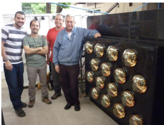
Figura 42. As PMTs montadas na tampa do detector ao lado dos pesquisadores, da esquerda para a direita: Carlos Eduardo Tanajura, Germano Guedes, Iuri Pepe e João dos Anjos.
