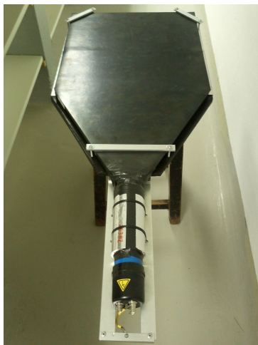
Figura 6.1: Placa cintiladora utilizada na medida do fluxo de múons.
