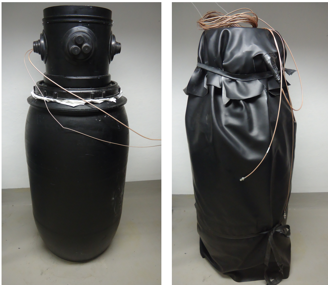
Figura 6.16: O tanque fechado e posteriormente com a vedação contra luz.
