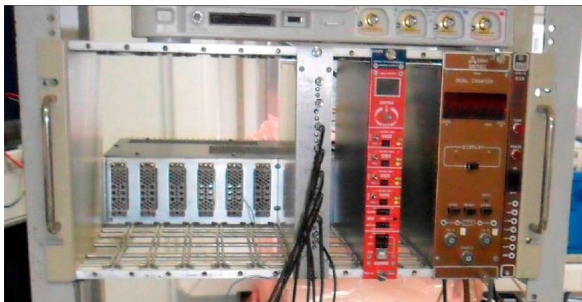
Figura 36: Front-End conectado ao crate NIM, módulo com os cabos lemo conectados.
