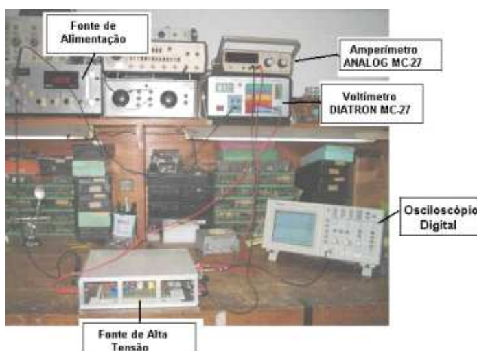
Figura 7 – Protótipo na bancada de testes.
