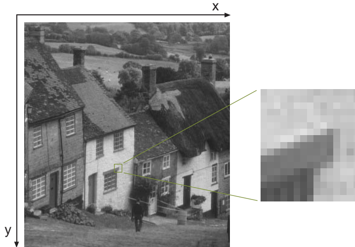
Figura 1. Imagem monocromática “Goldhill” com destaque para uma região de 17 x 17 pixels
