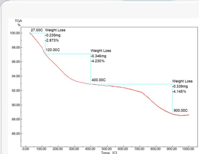
Figura 3: Perda de massa por termogravimetria de uma hidroxiapatita carbonatada sintetizada em temperatura de 90°C. Observa-se perda de 2,873% entre 27°C a 120°C; 4,230% entre 120°C a 400°C; e 4,145% entre 400°C a 900°C.
